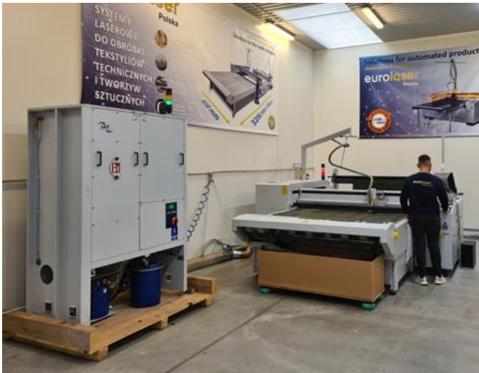
Bild 3: Die Absauganlage LAS 800 (links) beseitigt Laserrauch und -staub
