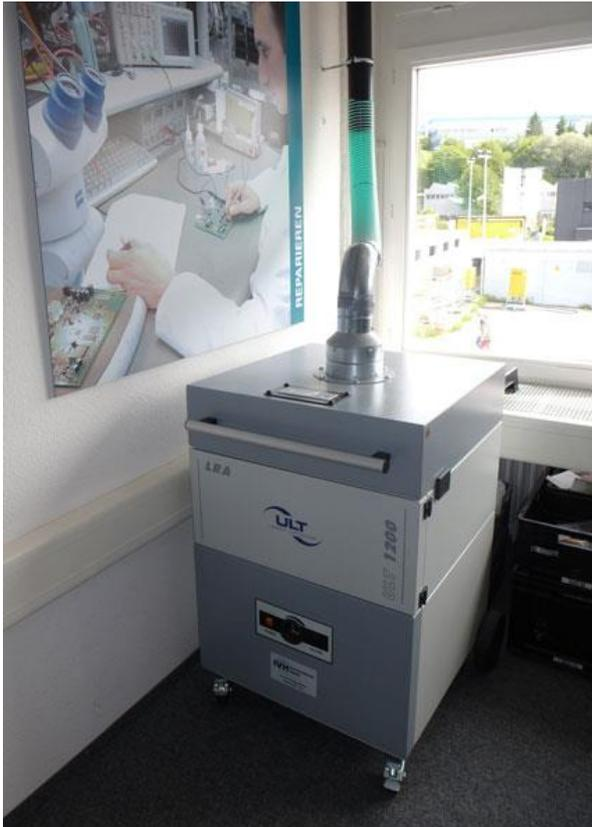
*Bild 4: LRA 1200 als zentrale Absauganlage für Lötrauch*
