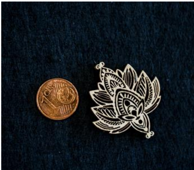
Bild 1: Feinster Laserschnitt in 5 mm Birkenperrholz
