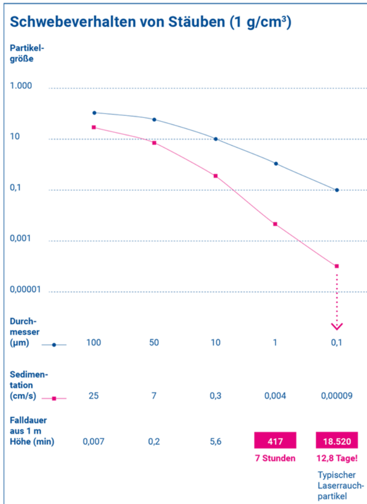
Bild 2: Sedimentation von Partikeln
