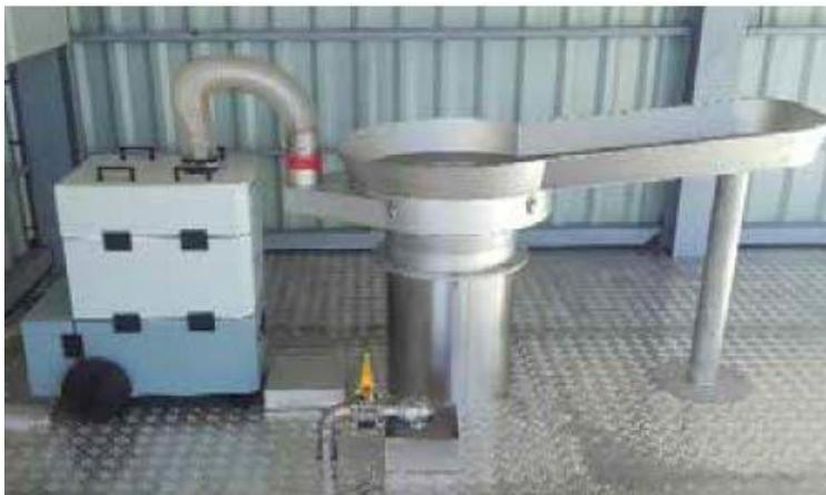
*Bild 5: Fassabsaugung zum Erfassen aufsteigender feiner Stäube*
