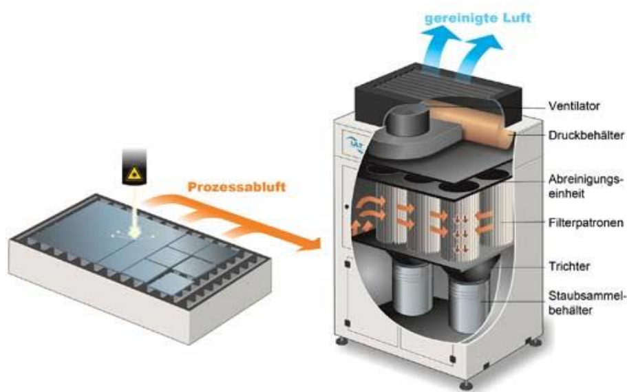
Bild 4: Filterprinzip Patronenfiltersystem
