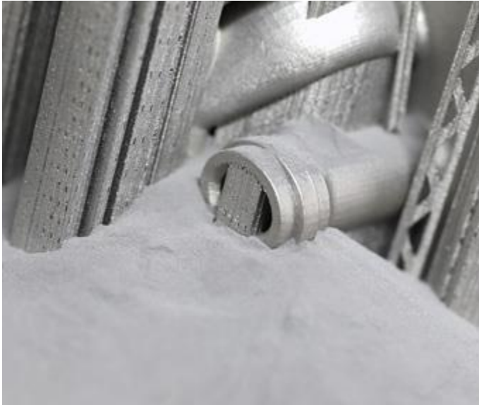
Bild 2: Metallpulverbett (Quelle: Solukon)
