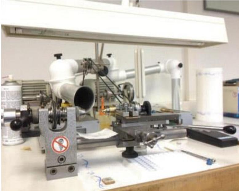
*Bild 1: Speziell konfigurierter Absaugarm an einer Drehmaschine (Bildquelle: Lange Uhren GmbH)*
