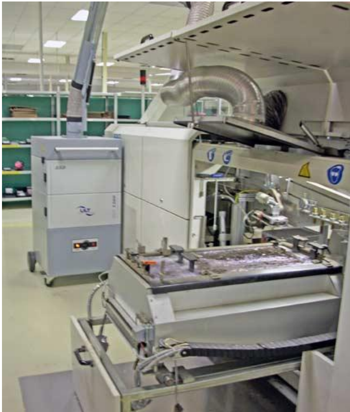
Bild 2: Absaugen und Filtern giftiger Stäube bei Wartung des Schwalllötovens mit ASD 1200
