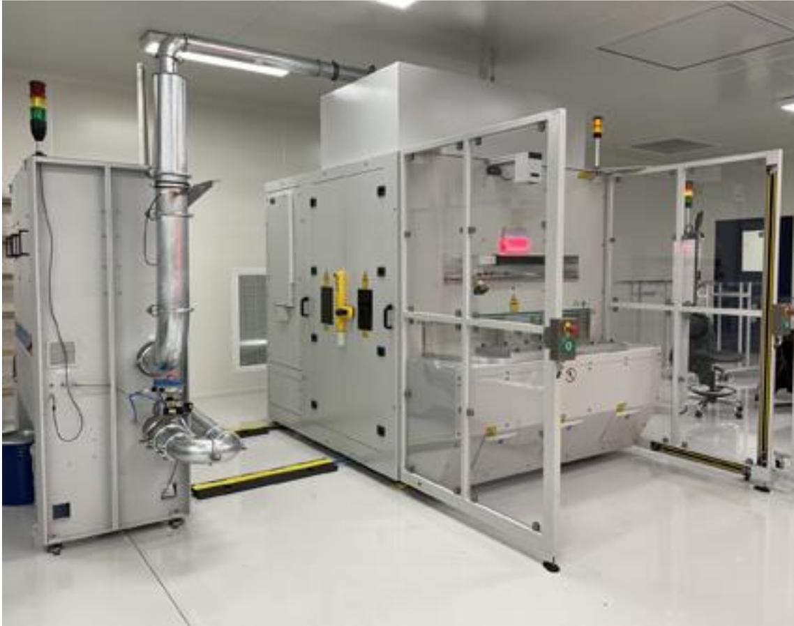
*Bild 4: Absauganlage LAS 800 Ex (links) im Einsatz mit einer cleanLASER-Laserreinigungsanlage (©cleanLASER)*
