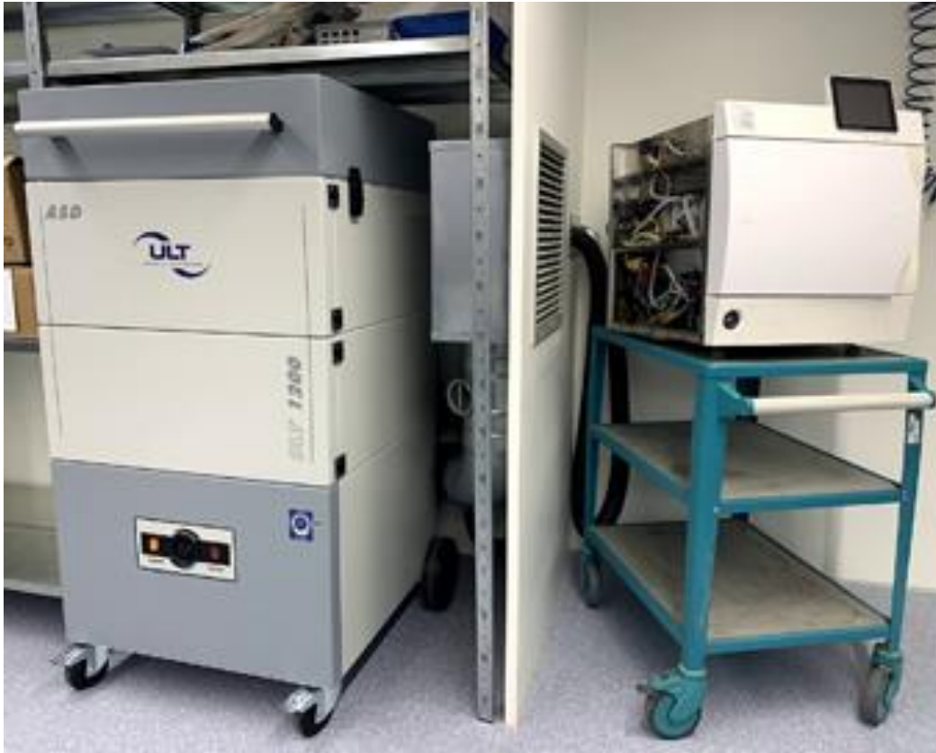
Bild 4: Reinigungskabine mit Kundengerät – die Stäube werden direkt abgesaugt
