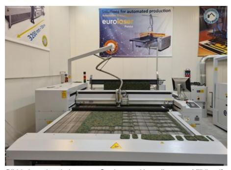
Bild 2: Laserbearbeitung von Cordura zur Herstellung von Militäruniform-Prototypen
