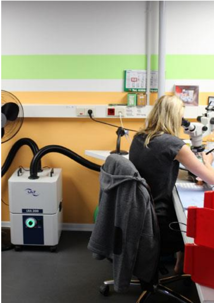
Bild: Mobile Lötrauchabsaugung mit dem System LRA 200
