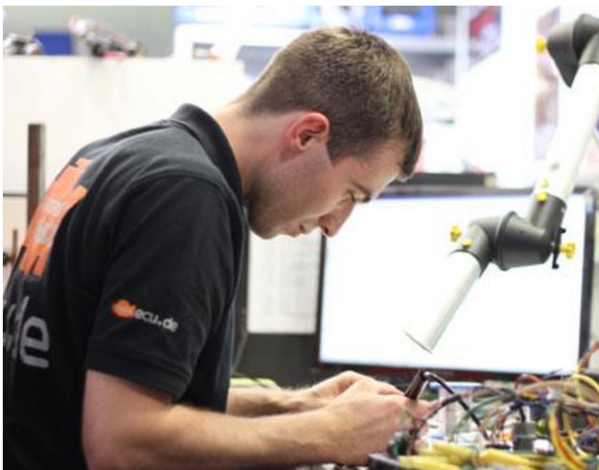
Bild: Lötarbeiten am Steuergerät – Schadstoffeffassung mit Alsident-Absaugarm
