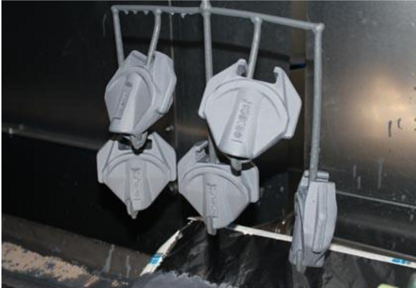
*Bild 4: Gussteile nach Beschichtung im Tauchbad mit Primer*
