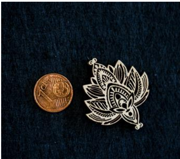
Bild 1: Feinster Laserschnitt in 5 mm Birkensperrholz
