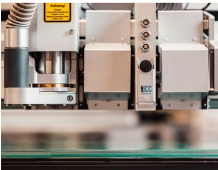
Bild 2: Ein integriertes Kameramodul ermöglicht hochpräzises Laserschneiden
