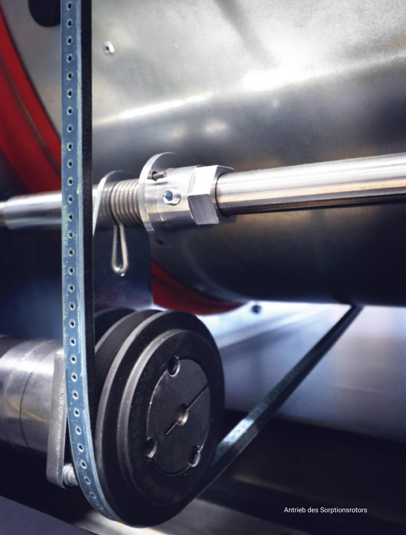
Antrieb des Sorptionsrotors
