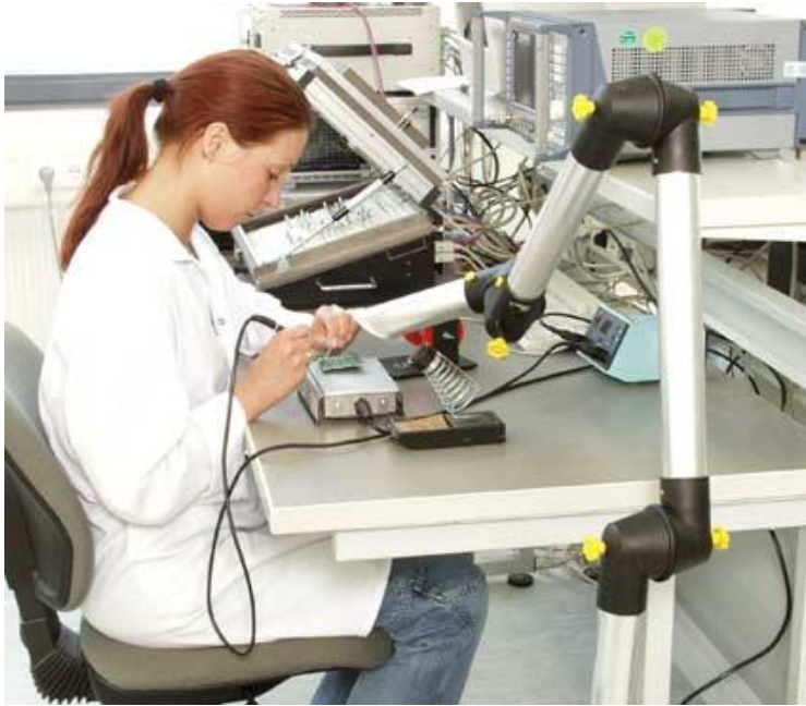
Bild 5: Absaugarm zur Erfassung von Löt Rauch am Handarbeitsplatz
