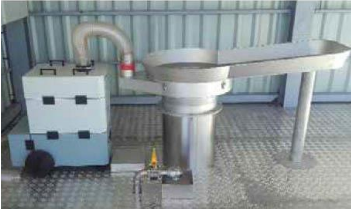
Bild 5: Fassabsaugung zum Erfassen aufsteigender feiner Stäube
