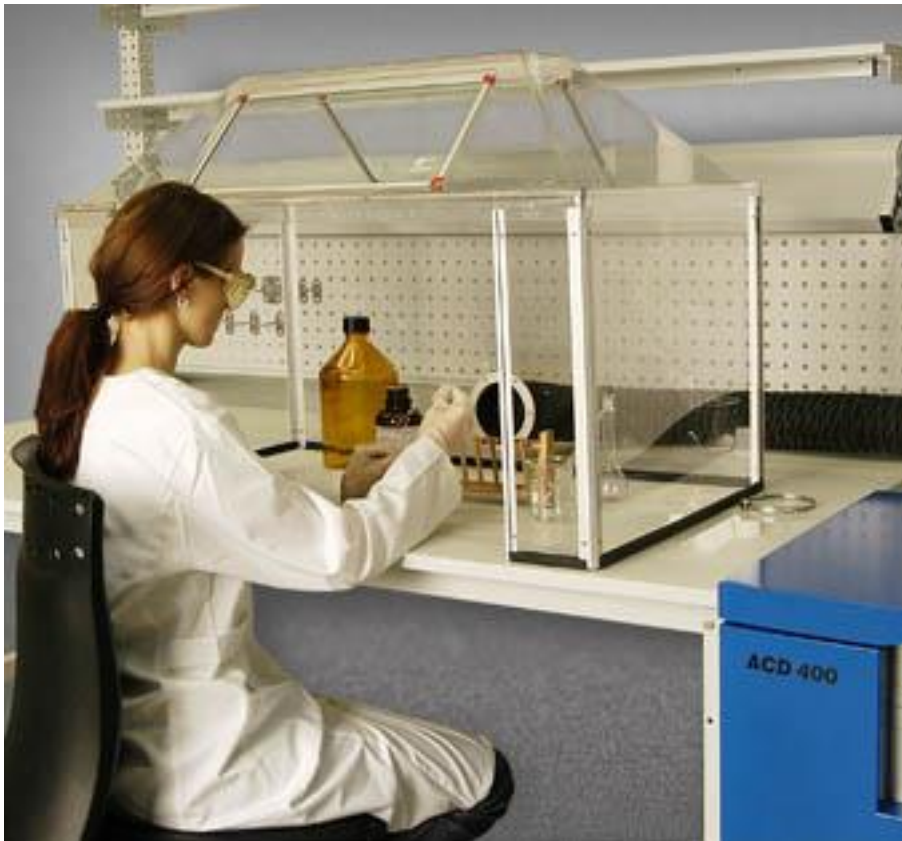
Bild 3: Halboffenes Absaugkabinett zum Einsatz, z.B. in Laboren
