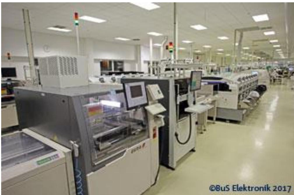
*Fertigungslinie für elektronische Baugruppen (© BuS Elektronik/Neways)*
