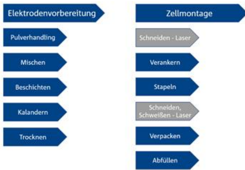
Abb. 6: Prozessschritte der Batteriezellfertigung
