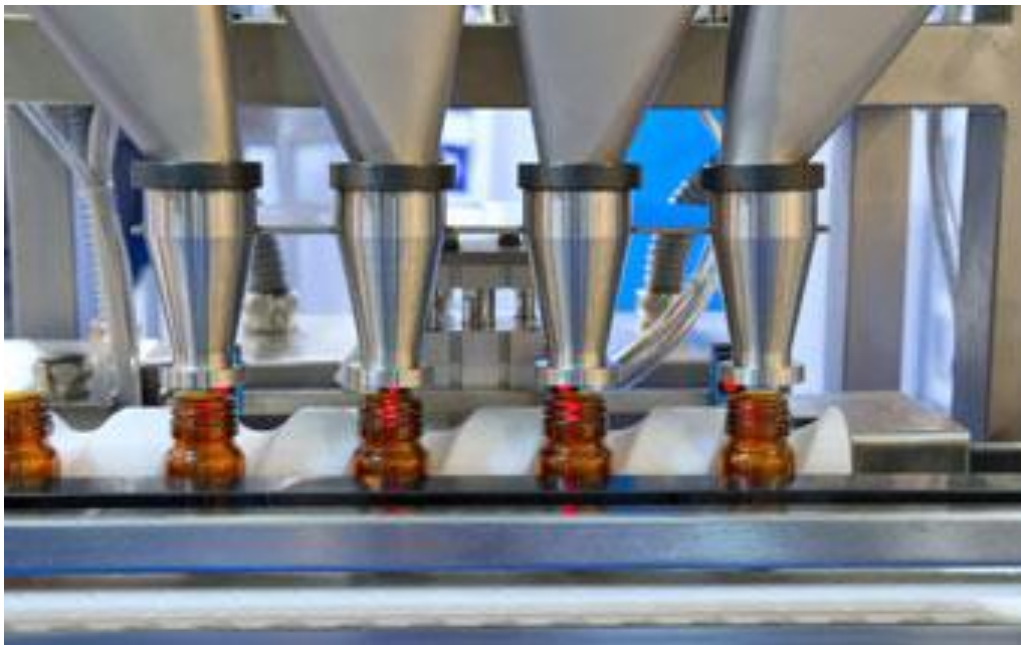
Bild 1: Anlage zum Abfüllen von Pharma- und Biopharmaprodukten
