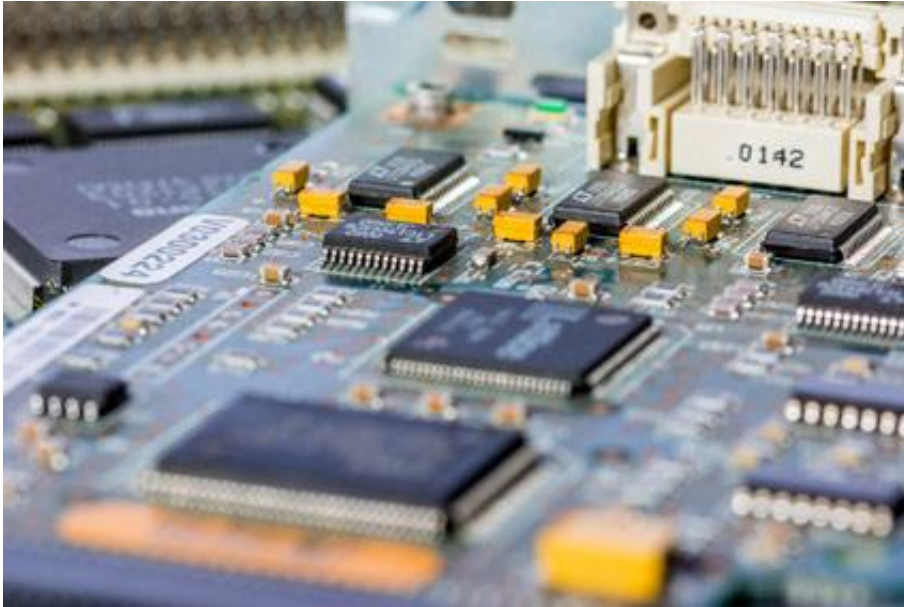
Bild 1: Baugruppe ohne Schutzlackierung
