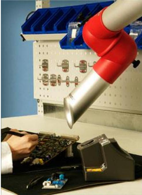
*Bild 4: Lötrauchabsaugung an manuellem Arbeitsplatz – Einsatz einer Saugspitze am Absaugarm*
