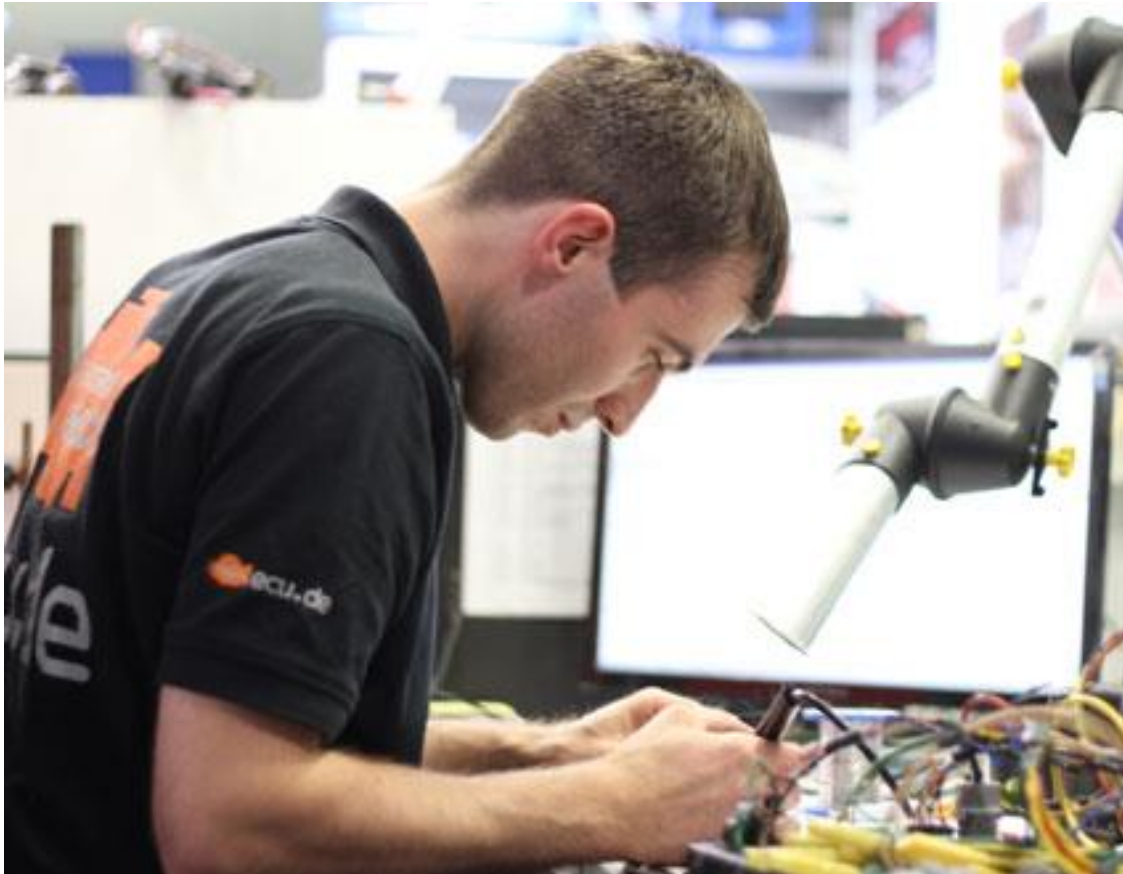
Bild 2: Absaugarm mit Erfassungselement zur Beseitigung von Löt Rauch
