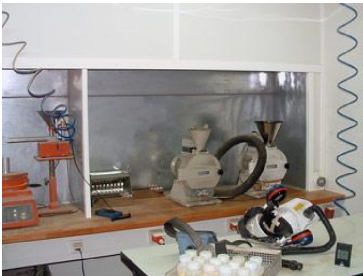
Bild: Rückwandabsaugung in einem Labor in Tschechien
