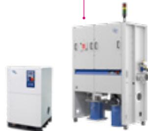
• Das Elektrodenband (Muttercoil) wird u. a. per Laserschneiden in mehrere kleinere Elektrodenbänder (Tochtercoils) zerteilt
