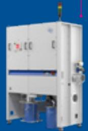
• Nach dem Beschichten wird die Trägerfolie getrocknet
