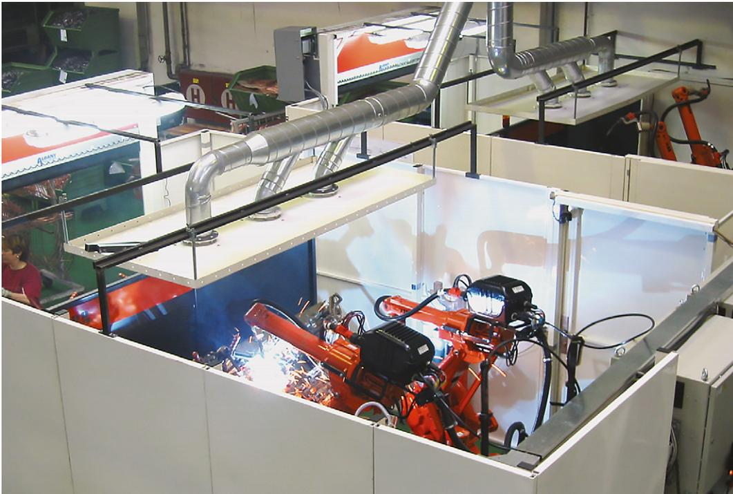
Bild A.5: Beispiel für eine Erfassung mittels Düsenplatten über Schweißrobotern
