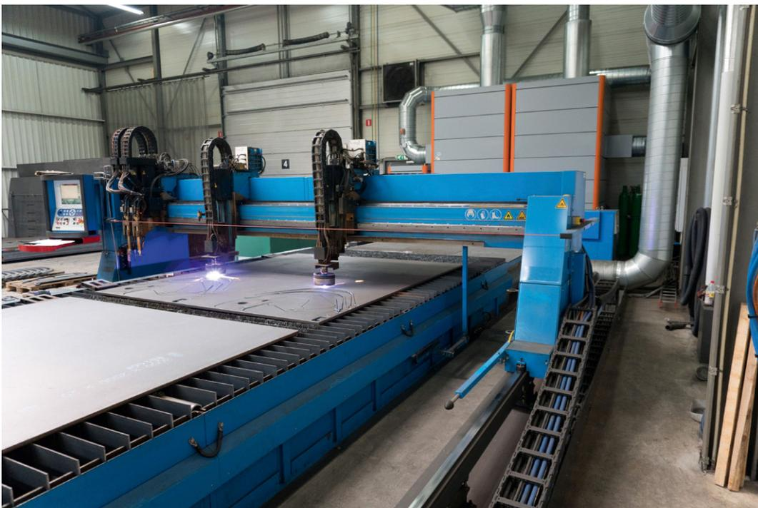
Bild A.6 Beispiel für eine (integrierte) Erfassung der Rauche beim Plasmaschneiden in einem Schneidisch mit segmentweiser Absaugung
