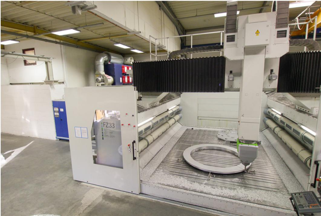
Bild A.3: Beispiel für eine Kühlschmierstoff-Absaugung (halboffene Bauart) mit Unterstützung durch Erzeugung eines Luftvorhangs (Blasstrahl) oberhalb der Emissionsquelle
