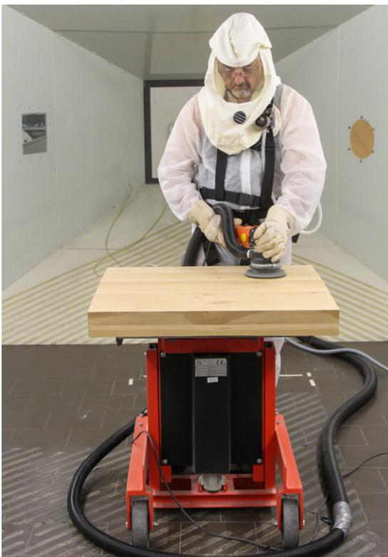
Bild A.10: Beispiel für eine Stauberfassung mittels integrierter Absaugeinrichtung an einer Schleifmaschine
