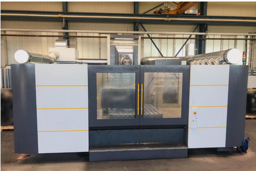
Bild A.4: Beispiel für eine Erfassung von Emulsionsnebel aus einer oben offenen Bearbeitungsmaschine mit Zuluftunterstützung
