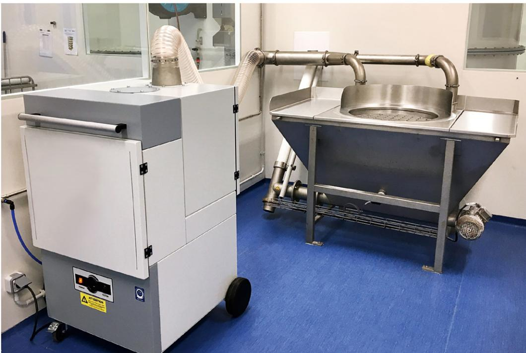
Bild A.8: Beispiel für eine Staubabsaugung mittels Ringspalterfassung an einer Einfüllereinrichtung
