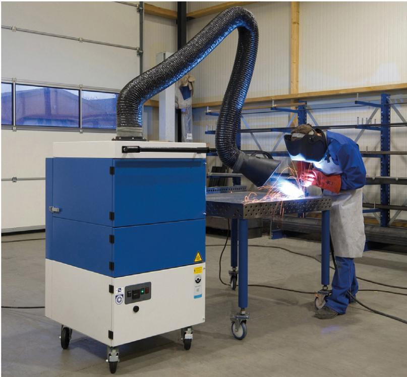
Bild A.7: Beispiel für eine Erfassung von Schweißrauch mit einer Absaughaube an einem flexiblen Absaugarm
