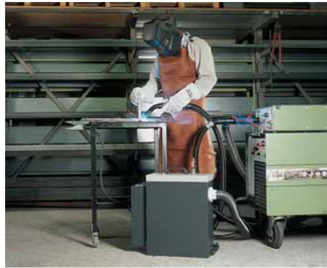
Bild 3: Schweißbrenner mit integrierter Absaugdüse
