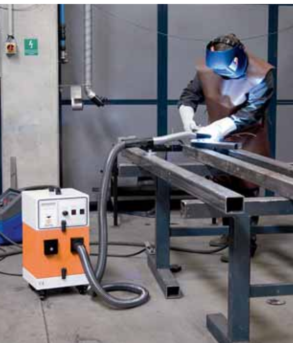
Bild 4: Hochvakuum-Punktabsaugung Quelle: KEMPER GmbH
